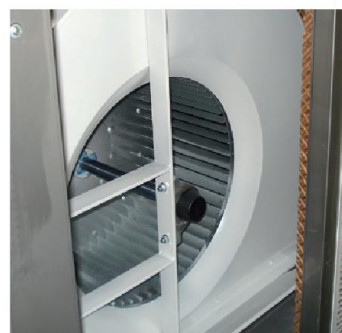
Sestava ventilátoru s opatření antikorozi (s žárově pozinkovaného rámu) se speciálním nátěrem a RAL7035 šedé barvě.
