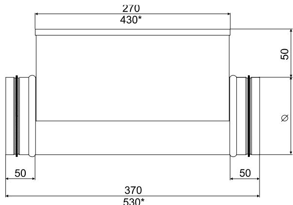
Pro ohřev čerstvého vzduchu přiváděného do jednotlivých místností a zón s individuálně řízenými teplotami. Ve správně navržených systémech mohou rovněž vytáhnout celou budovu. Kruhová elektrická potrubní topná tělesa je rovněž používají pro předehřev nebo meziúhřev pro ventilační zařízení.
