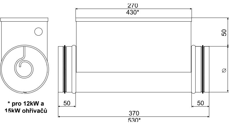
Pro ohřev čerstvého vzduchu přiváděného do jednotlivých místností a zón s individuálně řízenými teplotami. Ve správně navržených systémech mohou rovněž vytápět celou budovu. Kruhová elektrická potrubní topná tělesa je rovněž používají pro předehřev nebo meziohřev pro ventilační zařízení.
