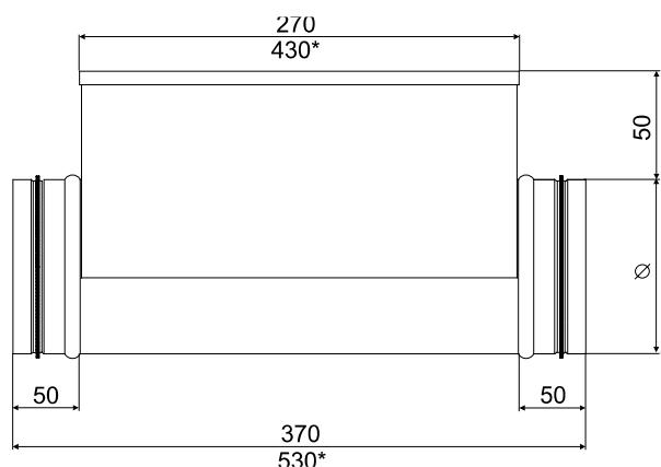
Pro ohřev čerstvého vzduchu přiváděného do jednotlivých místností a zón s individuálně řízenými teplotami. Ve správně navržených systémech mohou rovněž vytápět celou budovu. Kruhová elektrická potrubní topná tělesa je rovněž používají pro předehřev nebo meziohřev pro ventilační zařízení.
