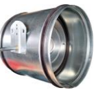
DLCXTE150 AISI304 Škrťící klapka těsná - nerezové provedení, do 200°C, Ø150mm
