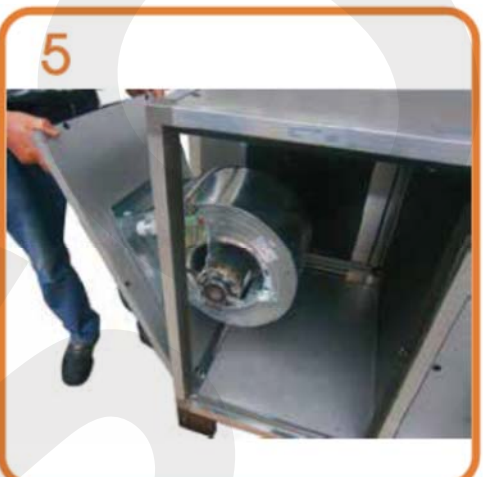
Vyměňte dva panely a připojte kabeláž ventilátoru.
