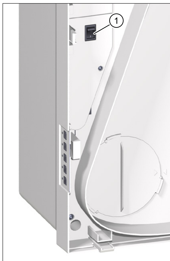
Obr. 12: Síťový spínač, viditelný po sejmutí víka přístroje
