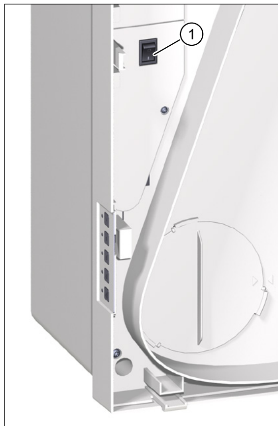
Obr. 13: Síťový spínač, viditelný po sejmutí víka přístroje
