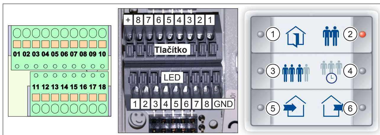
Obr. 5 Připojení dotykového senzoru InControl k ventilační jednotce M-WRG-S/Z-T
