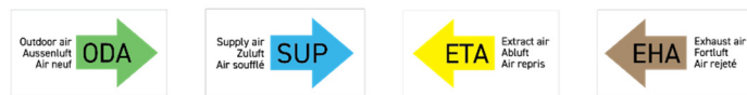
Obr. 2.3 Indikace připojení potrubí. ODA - venkovní vzduch; SUP - přiváděný vzduch; ETA - odváděný vzduch; EHA - výfuk vzduch.
